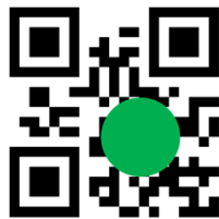
図4: 「文武両道」の1-H型QRコード 情報の欠損がみられるが読み取りは可能である。
